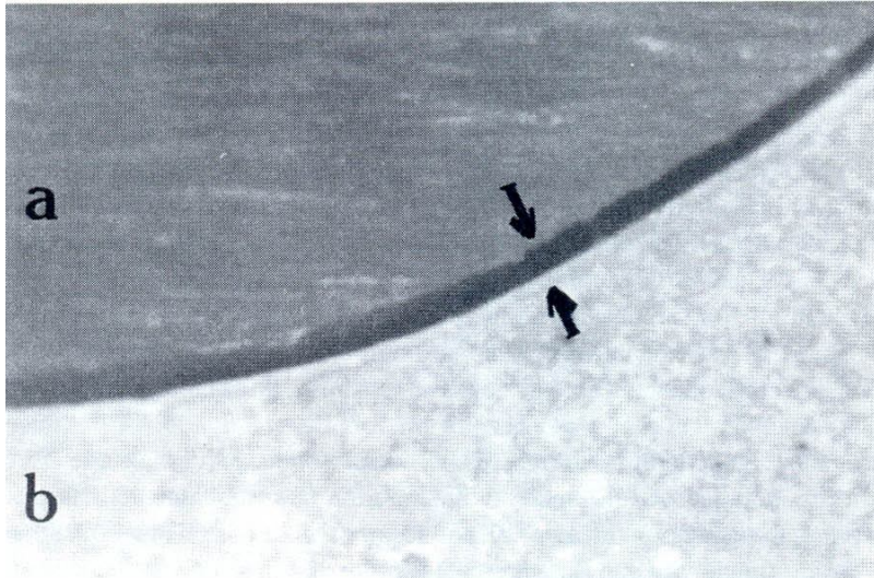
FIGURA 6- Desadaptação da base ao modelo de gesso (seta): a-) base de resina; b-) modelo de gesso (X 16)
