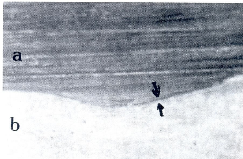
FIGURA 5- Adaptação satisfatória da base ao modelo de gesso (seta): a-) base de resina; b-) modelo de gesso (X 16)
