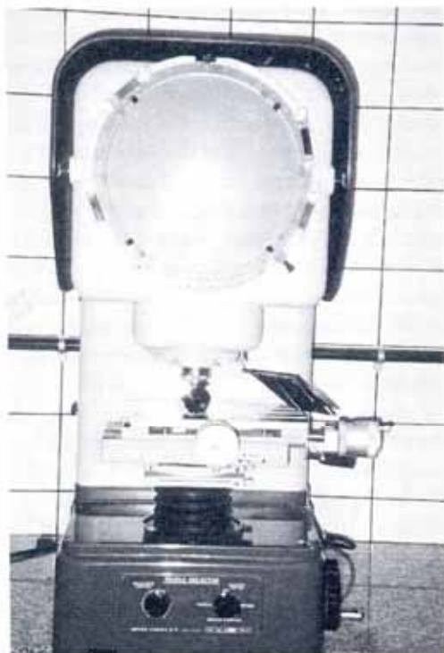
FIGURA 1 - Profile Projector da Nikon (Perfilômetro), que analisou a extensão da infiltração marginal nos dentes desgastados.
