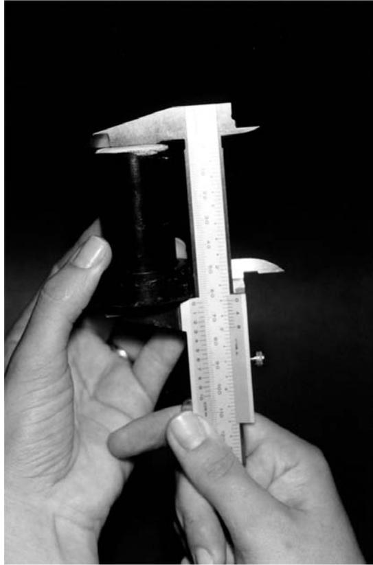
FIGURA 3 – Paquímetro obtendo comprimento final do cilindro de gesso.
