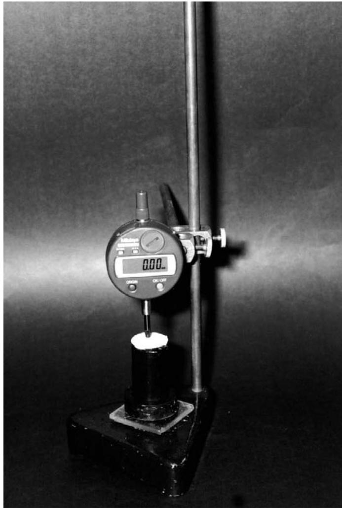
FIGURA 2 – Relógio Mitutoyo in/mm. Dispositivo para medir expansão de presa de cada material.
