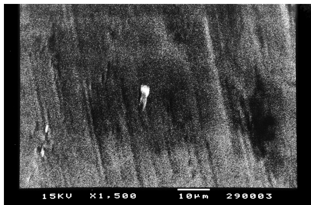
FIGURA 2 – Observe a superfície da peça do grupo I com leves ranhuras produzidas pelo processo de usinagem.
