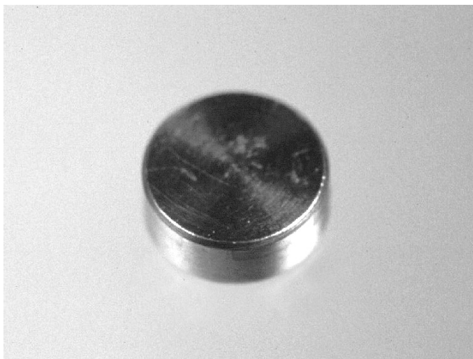
FIGURA 1 - Fotografia do protótipo de implante: disco de Ti cp com 4,76 mm de diâmetro e 2 mm de espessura.
