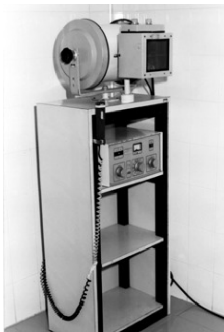
FIGURA 1 – Sistema Radiológico Adaptado, composto por um tubo Roentax 100 (empresa Emic São Paulo), com capacidade de 100 mA e 90KVp, montado em uma base de madeira revestida em fórmica, acoplado a um mecanismo luminoso de direcionamento do feixe.
