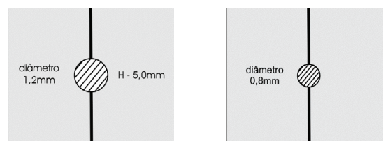
Figura 2 - Desenho da matriz para confecção da parte coronária do corpo de prova.
