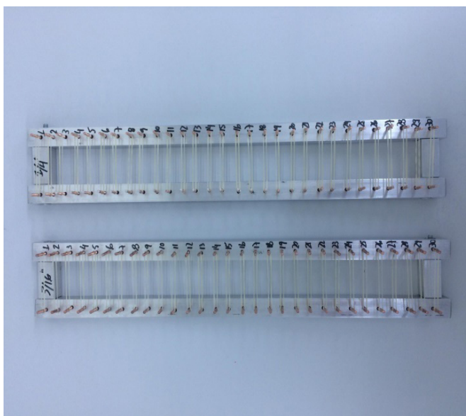
Figura 1 - Dispositivo para distensão dos elásticos.
