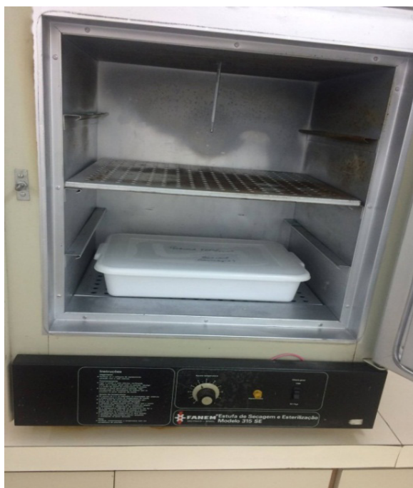
Figura 4 - Estufa na temperatura de 37°C, simulando a temperatura do meio bucal.
