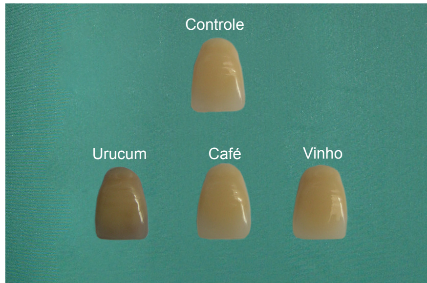
Figura 3 - Corpos de prova após a imersão em solução corante
