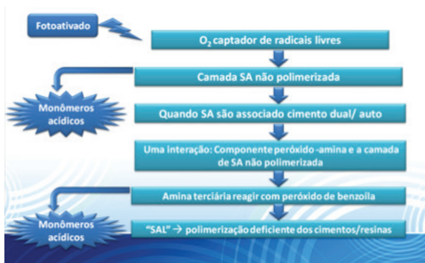
Figura 8 - Figura esquemática da incompatibilidade química dos sistemas adesivos simplificados com os cimentos resinosos dual/auto polimerizáveis. (Fonte: figura provida pelos autores)
