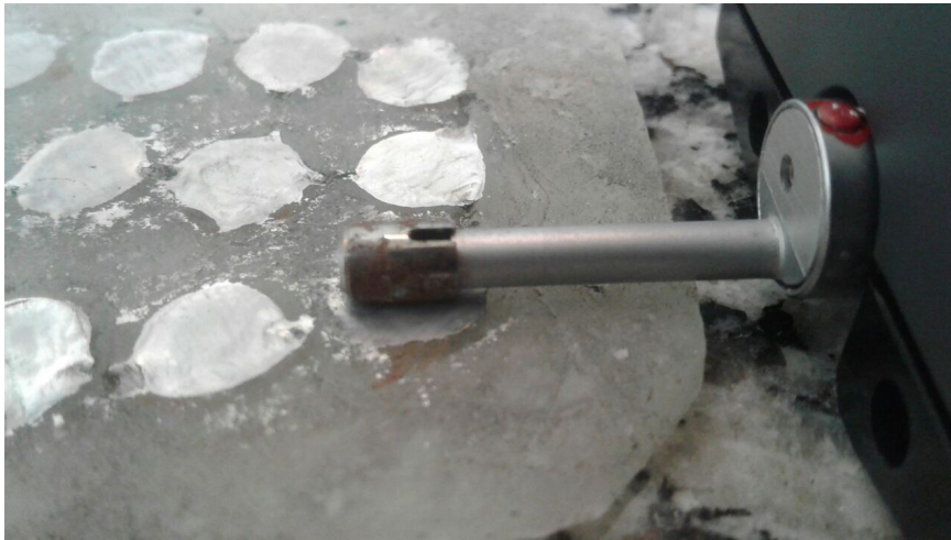
Figura 2 - Análise da rugosidade utilizando o Rugosímetro Digital Portátil ITRPSD-200.
