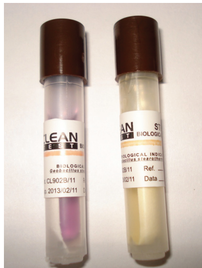
Figura 1 – Indicador biológico (cor púrpura) após ativação e incubação mostrando a ausência de microrganismo. A mudança de coloração para amarelo indica presença de microrganismo (sem contato com temperatura de esterilização).
